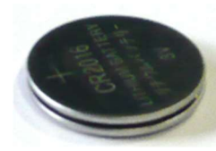
新電池を 2 段重ねにし カバー装着後取付ける。
